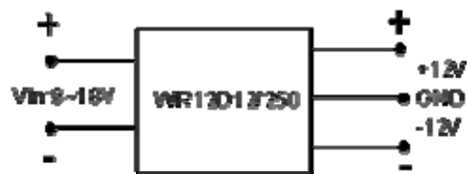
输入 9-18V, 输出±12V 原副边隔离使用
